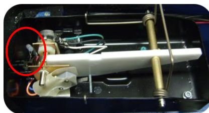
1 resistor 220 OHMS no pedal do acelerador(3)
