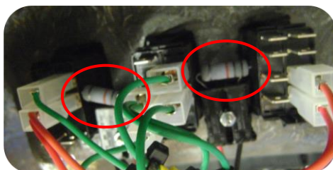
1 resistor de 220 OHMS entre cada botão
