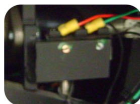
1 resistência de 25W no micro do freio(2)
